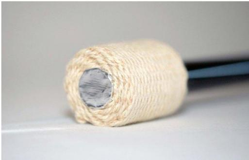
1. **Stoppino** : deve essere utilizzato solo ed esclusivamente materiale in Kevlar (in corda o fascia) collegato allo strumento di fuoco tramite un metodo di fissaggio sicuro. Filo di ferro, viti metalliche e/o bulloni dovrebbero essere fissati sotto lo stoppino al fine di non incorrere in scottature da contatto o abrasioni. Collanti o materiali sintetici non sono un metodo sicuro per il fissaggio dello stoppino.
